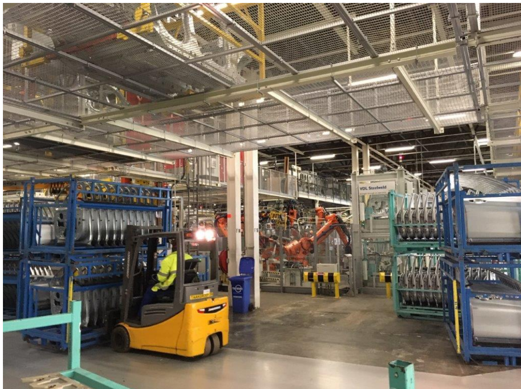
Figuur 2.4: Beeld van het transport van de pershal naar de carrosseriebouw. In de rekken kale persdelen, die gevoelig zijn voor verontreiniging, beschadiging en corrosie.
