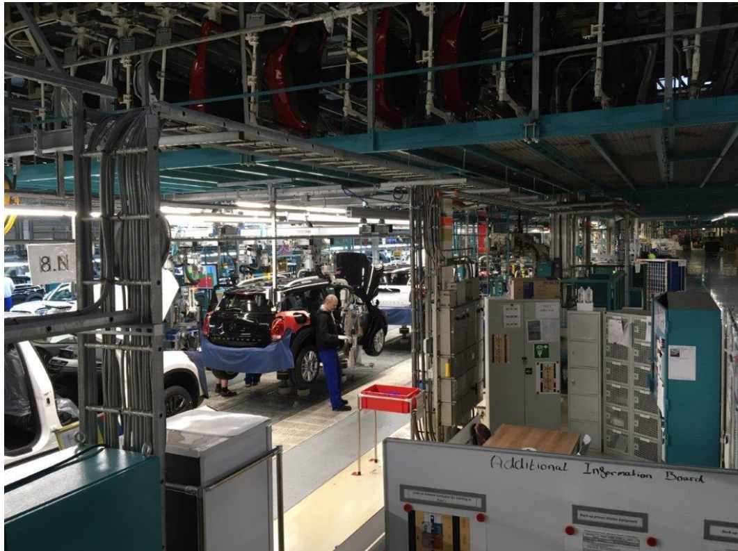
Figuur 2.7: FAS, bovenin is zichtbaar hoe onderdelen (autodeuren in dit geval) op een ander niveau worden getransporteerd.
